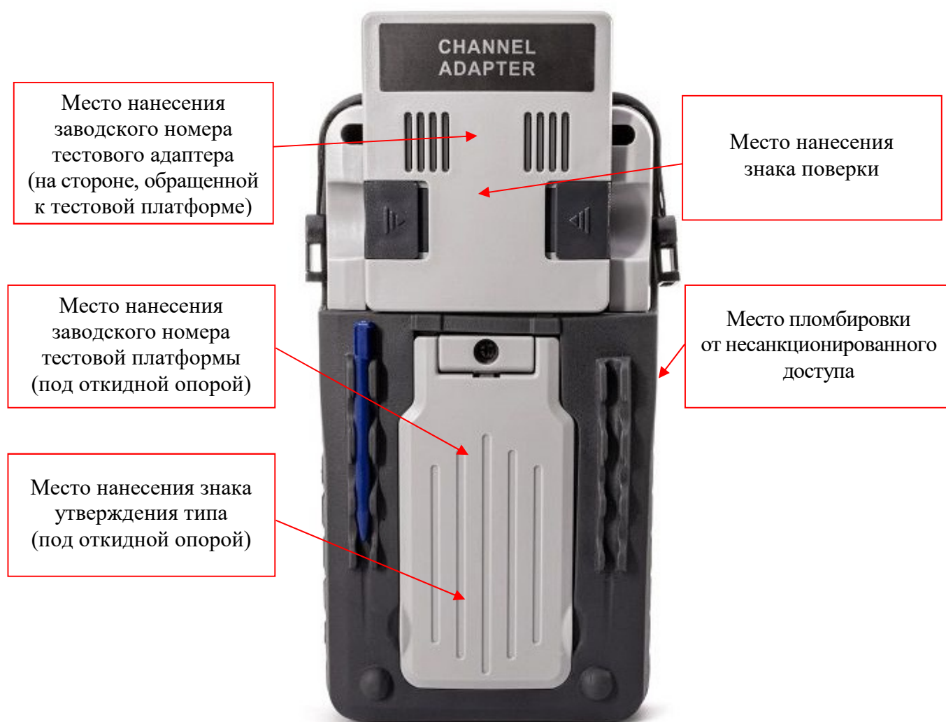
Рисунок 2 – Место нанесения заводского номера, место пломбировки от несанкционированного доступа, место наклейки знака утверждения типа
